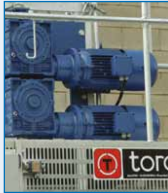
Grupo motriz: motorreductores con electrofreno integrado
